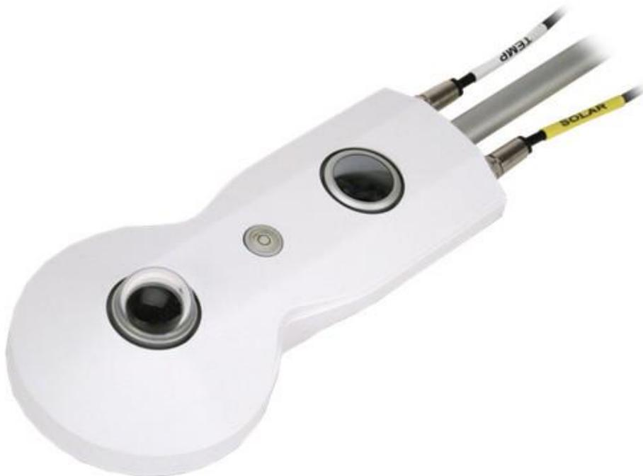
CNR4 标配 Pt-100 铂电阻和 10K 热敏电阻，用于测量仪器的内部温度，对所测量的辐射数据进行补偿修正，从而使测量数据更加准确、可靠。它配备的防水电缆使其能够避免降水或水汽对设备产生的不利影响。用户可以为 CNR4 选配具备加热功能的 CNF4 通风装置，不仅能够保证净辐射传感器周围环境的空气流通，进一步减小温度对测量产生的影响，而且其自带的加热装置能够有效融化覆盖在设备上的积雪、凝霜等，保证设备正常工作。CNR4 配有水平泡，使仪器的安装、使用与维护都非常方便。同时其使用的可拆卸安装支架为运输和使用都提供了极大的便利。
